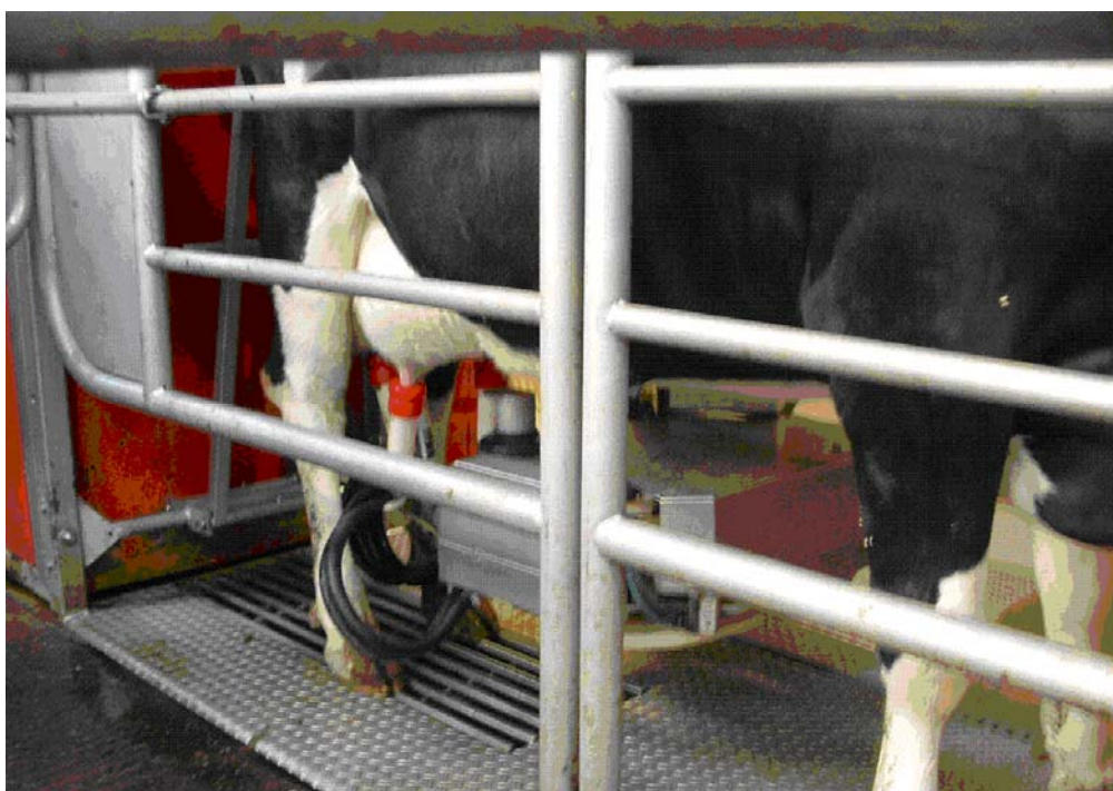
Εικόνα 8. Σύστημα αυτόματη άμελξης αγελάδων (ρομποτικό αρμεχτήριο)
